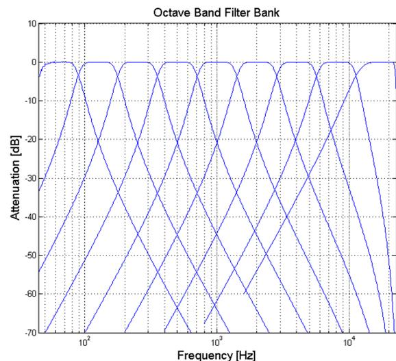
Fig. 4. Octave Band Filter Bank
